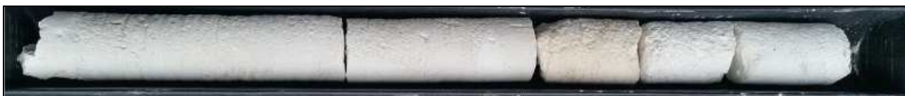
Figura 12 -- Substrato lapideo miocenico – calcari arenacei
