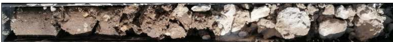
Figura 13 – Materiali di riempimento antropico eterogeneo
